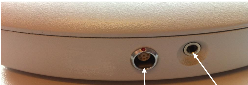
Anschluss für Kabel des Sensormoduls Anschluss für Kopfhörer (optionales Zubehör)
